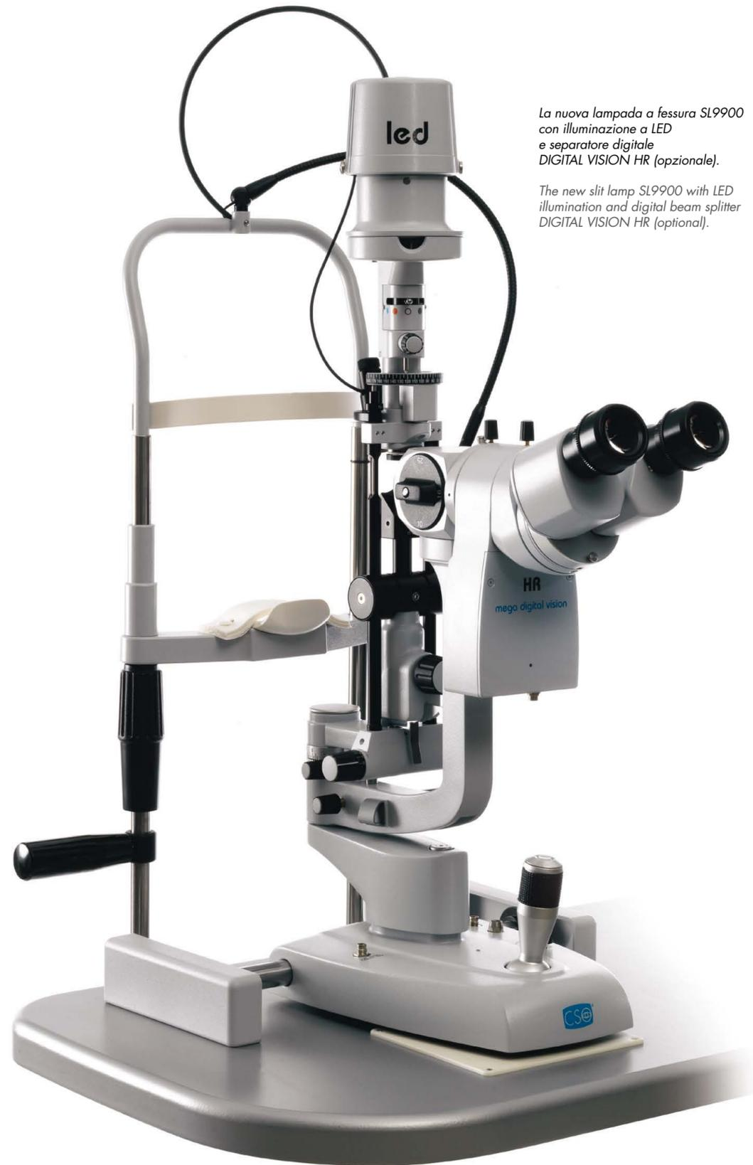
La nuova lampada a fessura SL9900 con illuminazione a LED e separatore digitale DIGITAL VISION HR (opzionale).
