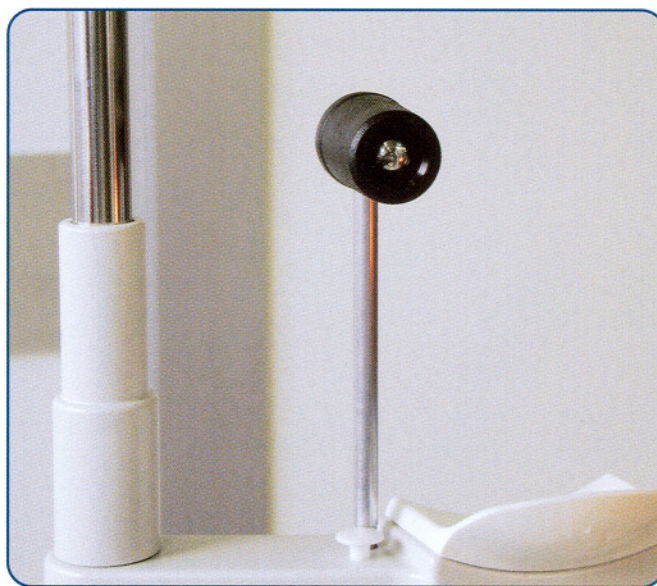
Sfera di prova a 50 D Control sfera 50 D
