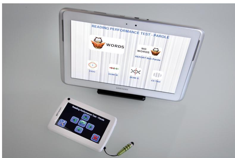
TETRA è composto da un tablet con schermo LCD ad alta risoluzione e luminosità calibrata, appositamente ingegnerizzato per una semplice e rapida esecuzione dei test. Un telecomando touch-screen interattivo permette un facile controllo dello strumento. Ricerca, sperimentazione e tecnologia hanno dato vita ad un prodotto professionale ed innovativo.
